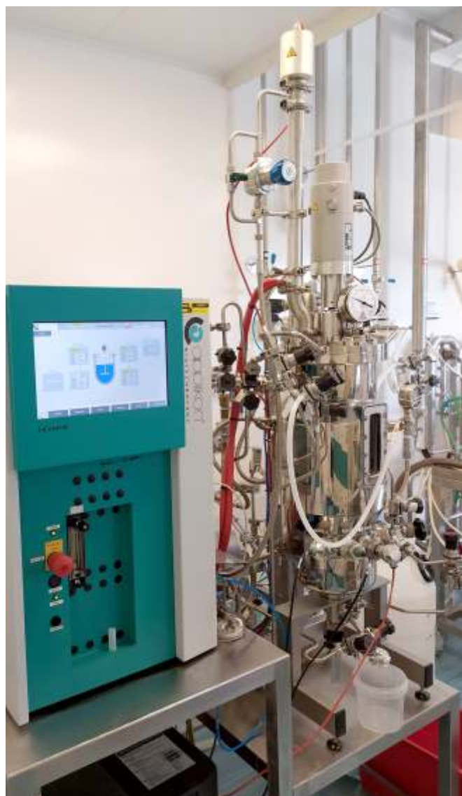
Bioreaktor Applikon 20 L pro výrobu antigenu Bordetella bronchiseptica
