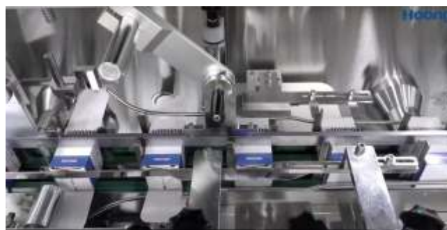
Jednotlivé fáze adjustace: složení krabičky, vložení příbalového letáku, vložení lékovky a zavření krabičky
