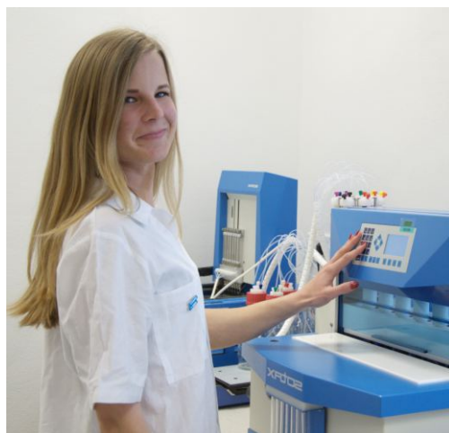
Mgr. Darja Bučková, disoluční jednotka SOTAX CE 7 Smart, testy uvolňování meloxicamu ze suspenze
