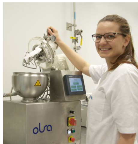
Mgr. Šárka Navrátilová, formulační kotlík MINILAB 2G, příprava suspenze meloxicamu
