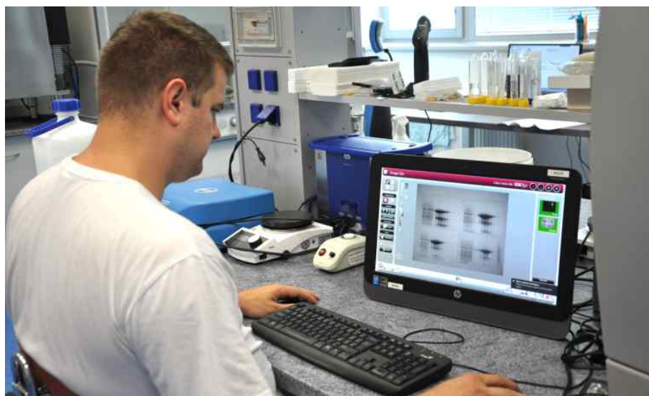
Ing. Juraj Kučerák, Ph.D., pomocí přístroje SYNGENE G:BOX vyhodnocuje úspěšnost purifikace proteinu v jednotlivých frakcích
