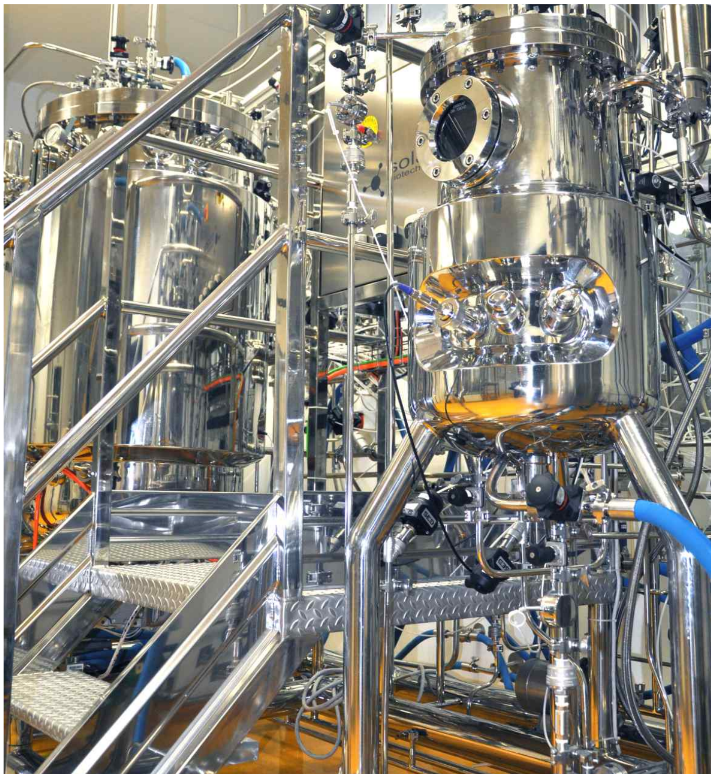
Bioreaktor SOLARIS SBI400 zabezpečuje efektivní kultivační proces virového antigenu. Bioreaktor má pracovní objem 300 litrů a měsíčně vyprodukuje max. 600 litrů antigenu s obsahem glykoproteinu (po inaktivaci) 40-80 IU/ml
