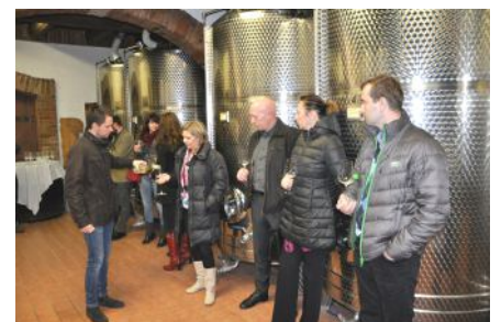
Nerezové nádrže o objemu 2000 litrů slouží k řízenému kvašení bílého vína
